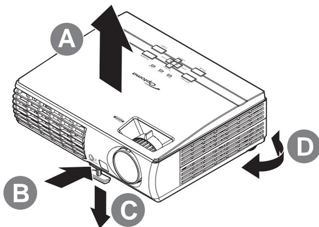
1. Для увеличения высоты проектора приподнимите проектор [A] и нажмите кнопку регулятора высоты [B].
