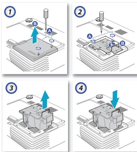
1. Освободите два невыпадающих винта на крышке отсека лампы (A). Снимите крышку отсека лампы (B).
